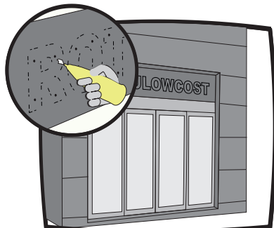
6.- Limpiar el polvo de los agujeros y rellenarlos con cola de montaje.
