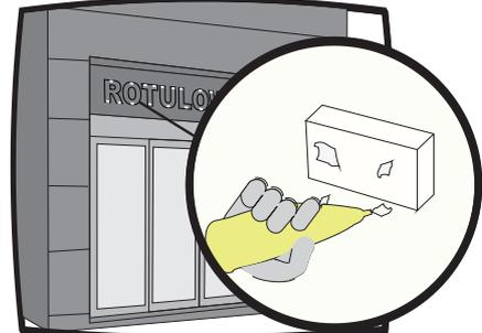
5.- Colocar los tacos de PVC en la pared, coincidiendo con las marcas realizadas. Utilizar cola de montaje espesa o también se pueden atornillar.
